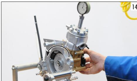
A valore raggiunto, con una mano tenere fermo la puleggia o l'albero motore nella parte opposta e con una chiave bloccare il dado del volano, ma senza eccedere. Riverificare che l'anticipo sia nei valori segnalati ( $1,7 \pm 0,1$ ) togliere la vite m.5x30 e montare la bobina. Prima di bloccarla con le due viti interporre fra bobina e volano uno spessore calibrato da 0,35 mm (foto 15). Procedere al bloccaggio definitivo del dado volano utilizzando una chiave dinamometrica a 40 Nm.
