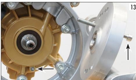
Avvitare il dado del volano senza bloccarlo in modo tale che l'albero motore possa girare nel volano. Avvitare nel foro della candela il supporto del comparatore, posizionare il comparatore e portare il pistone al punto morto superiore. Azzerare il comparatore e ruotare l'albero motore in senso antiorario di 1,7 mm guardando dal lato volano (vedi freccia foto 14).
