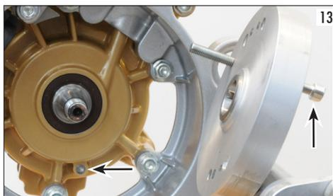
Visser l'écrou du volant sans le bloquer, de façon à ce que l'embellage puisse tourner dans le volant. Visser le support du comparateur dans le trou de la bougie; placer le comparateur et porter le piston on PMS. Remettre à zéro le comparateur et tourner l'embellage dans le sens inverse des aiguilles d'une montre de 1,7 mm du coté du volant (voir flèche photo 14).
