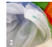
Heben Sie die Nylonstab aus der Tasche am Untersegel. Foto 2. Und ziehen Sie ihn heraus. Vergleichen Sie den alten Stab mit dem neuen Material und schneiden Sie dieses auf die korrekte Länge zu.
