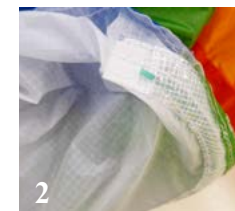
Vyjměte nylonovou výztuhu z obalu na konci dolního potahu. Foto č. 2. A vytáhněte ji. Poměřte starou výztuhu proti novému materiálu a nařežte na správnou délku.
