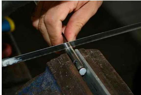
Рисунок 9 - Отрезание трубки датчика
